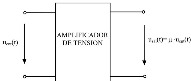
Figura 1. Esquemática de un amplificador de tensión.
